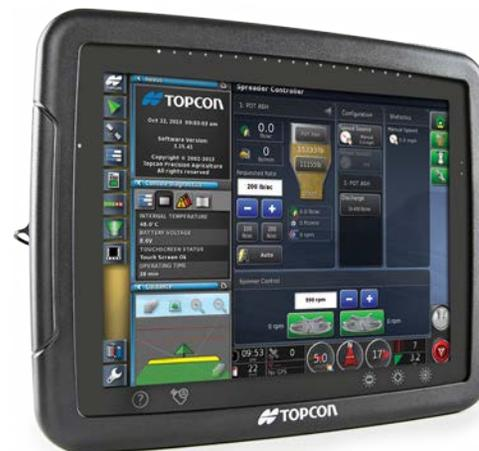
Las consolas X30 y X25 de Topcon con el software de Horizon ofrecen un control de tasa variable de gran precisión sobre fertilizantes líquidos o granulados.
