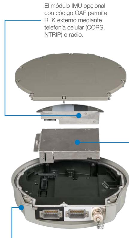
El módulo IMU opcional con código OAF permite RTK externo mediante telefonía celular (CORS, NTRIP) o radio.
